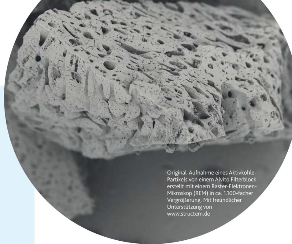
Original-Aufnahme eines Aktivkohle-Partikels von einem Alvito Filterblock erstellt mit einem Raster-Elektronen-Mikroskop (REM) in ca. 1.100-facher Vergrößerung. Mit freundlicher Unterstützung von [www.structem.de](http://www.structem.de)
